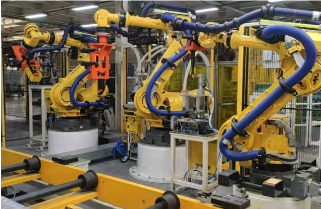
前轮罩&A柱加强板SOF螺栓自动送钉装配系统
